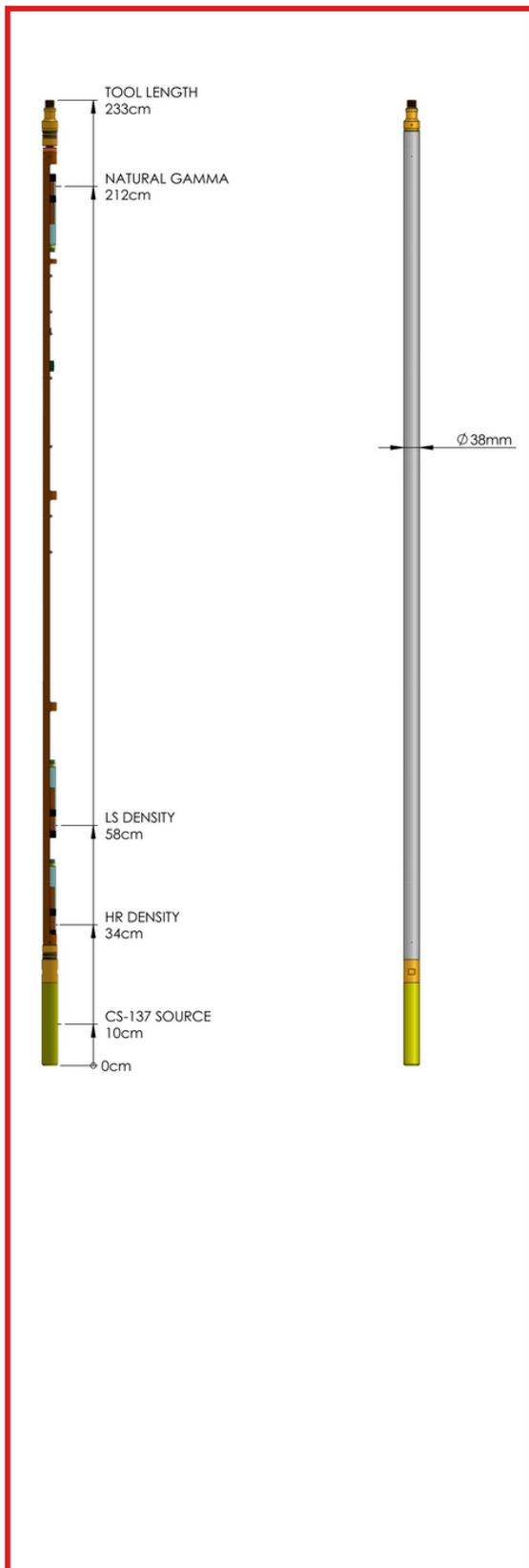
La sonde **TRS38G** fournit des mesures de densité globale à long espacement (LSD) et haute résolution (HRD), basées sur le principe de diffusion Compton, ainsi qu'une diagraphie gamma naturel.
