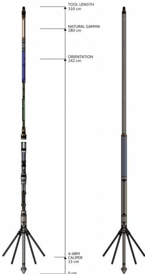
La sonde de mesure du diamètre de forage **4AC60** comprend deux paires de bras effectuant des mesures de diamètre perpendiculaires X-Y indépendantes. En même temps un système d'orientation magnétomètres / accéléromètres fournit les mesures d'azimut et d'inclinaison du forage ainsi que les directions X-Y des bras.
